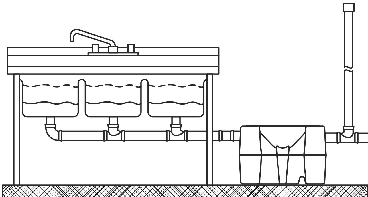
Данный вариант может использоваться в случае невозможности установки жироуловителя под мойкой или при установке одного жироуловителя для нескольких моек последовательно подключенных к канализационной трубе.
