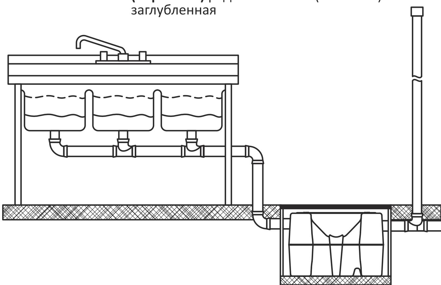
Данный вариант можно использовать в случае низкого пролегания труб над полом и в зданиях не имеющих подвальных помещений. Также вариант удобен при установке одного жироуловителя большей производительности для нескольких моек последовательно подключенных к канализационной трубе.
